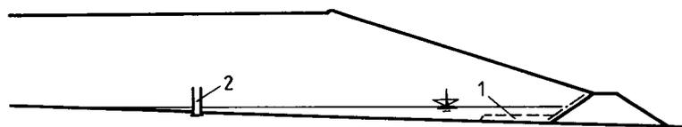
Pour assurer l'efficacité du drainage, le tapis drainant doit être construit au-dessus du niveau initial de la retenue et, en conséquence, ne jamais être submergé. Ceci peut être obtenu en donnant au tapis drainant amont une épaisseur suffisante, comme le montre la Fig. 8. Le tapis drainant se présente comme une « langue » à l'amont du remblai d'amorce.
