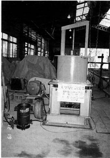
Photo 3 Consistency meter [diameter 48 cm (19 in)]. Appareil de mesure de la consistance (diamètre 48 cm).
