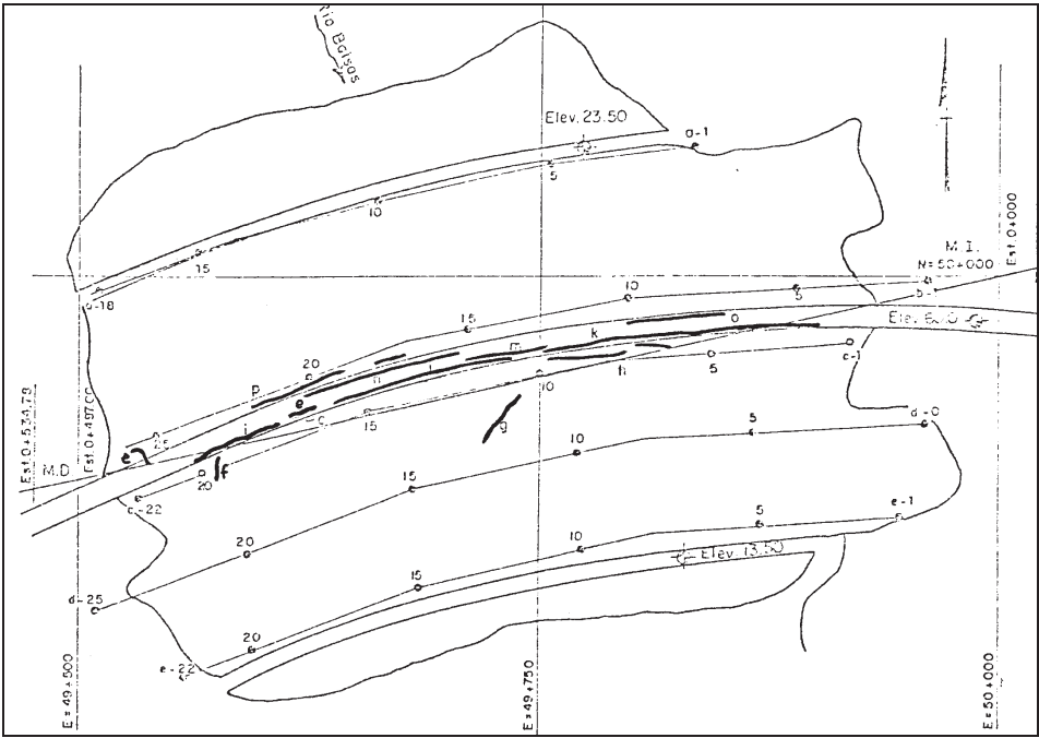
Fig. 8.3 La Villita Dam – Crack Location at La Villita Dam Barrage La Villita – Emplacement des fissures sur le barrage La Villita
